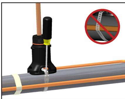
**Terminator:** Проложите кабель через ввод в основание и смонтируйте Expediter на трубе при помощи трубодержателя. **Не закрывайте при этом кабель.**
