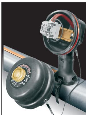
**ZS/ZE . . .** этот комплект обеспечивает сращивание или концевую заделку нагревательных кабелей Термон с наружной стороны изоляции, что облегчает доступ к ним рабочего персонала (если требуется T-образное разветвление, может использоваться комплект Terminator ZP).
