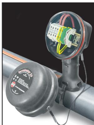
**ZL . . .** комплект с индикатором исправности цепи обеспечивает визуальную индикацию нагревательной цепи, находящейся под напряжением. Данный комплект можно использовать для подключения к питанию или концевой заделки. Подключение к питанию выполняется в клеммной колодке с использованием никелированных медных клемм, что обеспечивает непрерывную подачу питания по этому соединению в течение продолжительного периода времени.
